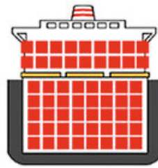
Disposizione classica dei container in una nave portacontainer.
